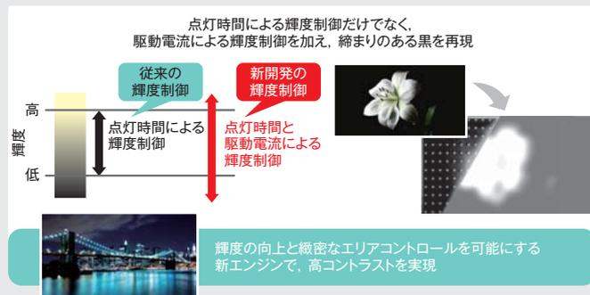
▲ 直下型LEDハイブリッドエリアコントロールの概要
