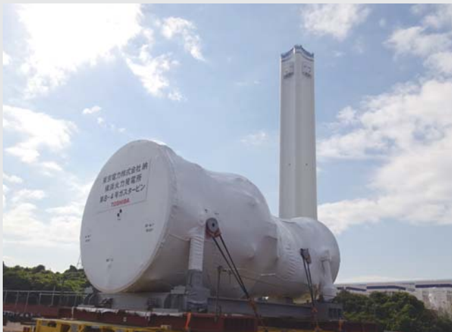
▲ 更新用のガスタービン Replacement gas turbine
