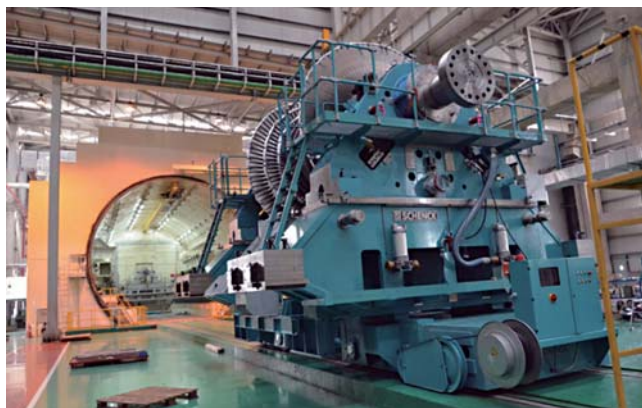
高速バランス試験設備とクドゥギ火力発電所 2号機タービンロータ
