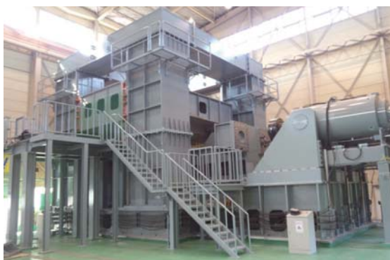
実規模免震装置破断試験の装置
