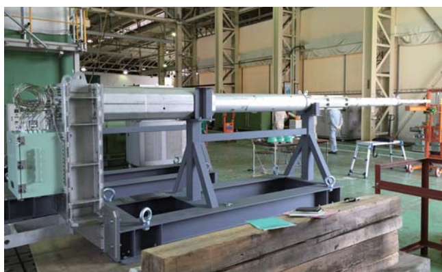
ヒートサーモ式使用済燃料プール水位温度計
