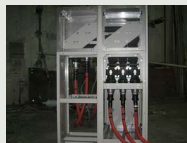
SIS undergoing certification test at Centro Elettrotecnico Sperimentale Italiano (CESI)
