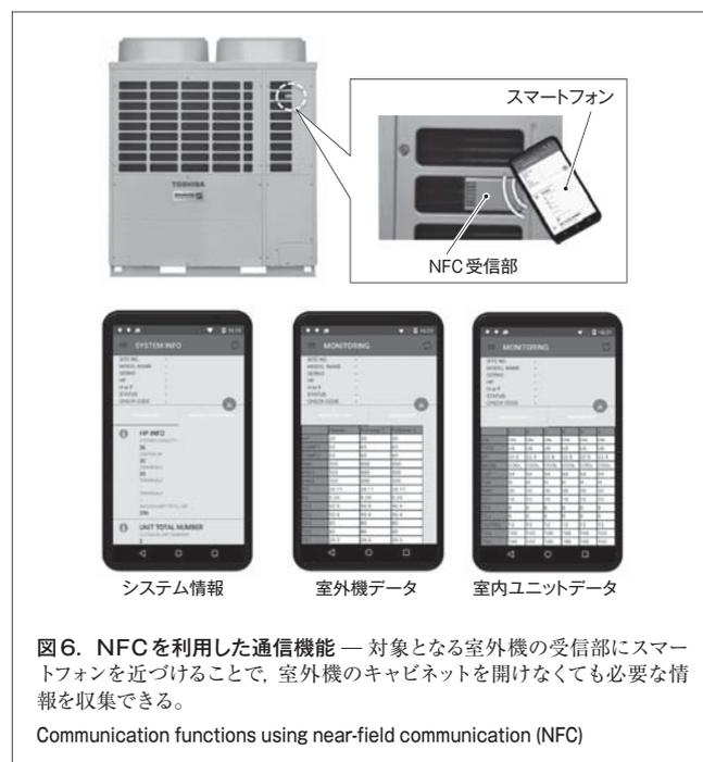
図6. NFCを利用した通信機能 — 対象となる室外機の受信部にスマートフォンを近づけることで、室外機のキャビネットを開けなくても必要な情報を収集できる。
