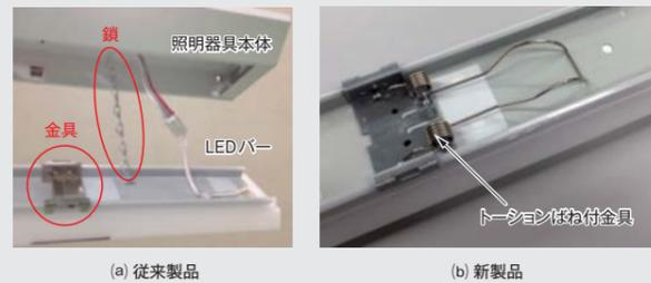
図1. DFMによる部品設計 — 従来製品に使われた鎖の代わりに、新製品ではDFMにより新たに設計したトーションばね付金具を採用しました。
