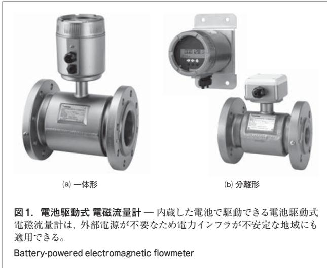
外部電源は不要であり、電力インフラが不安定な地域でも適用可能である。また、電磁流量計は内部に可動部がない構造のため、付着物の影響を受けにくく、正確な計量ができるという特長を持つ。
