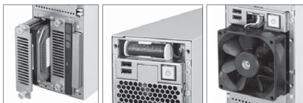
(a) ストレージ交換 (b) バッテリー交換 (c) 冷却ファン交換
