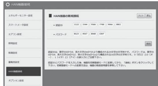
図2. HANアダプタを装着したフェミニティ家電機器の接続設定画面 — フェミニティ家電機器は認証IDとパスワードによって識別され、ホームゲートウェイに接続される。
