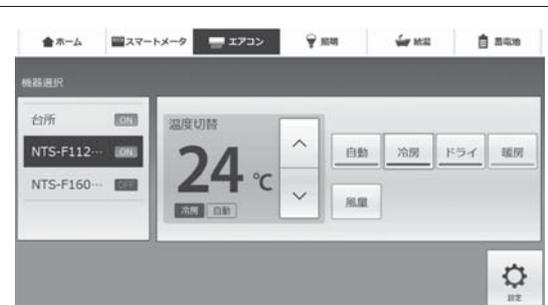
図3. エアコン制御サービス画面の例 — 接続する伝送メディアの種類に関わらず、共通の画面でフェミニティ家電機器を操作したり動作状態に関する情報を取得したりできる。
