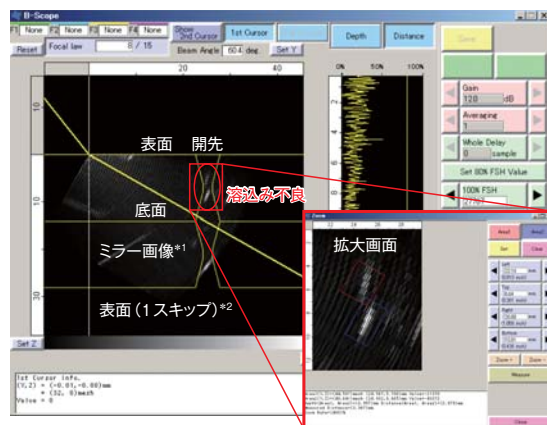
*1：底面からの反射により生じる鏡像 *2：1 回目の反射（1 スキップ）により生じた表面の鏡像
