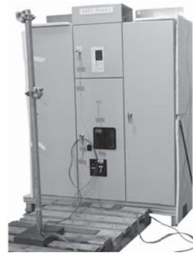
図8. HS6形の温度上昇試験のようす — IPHにおいてIEC規格に準ずる各種試験を実施した。
