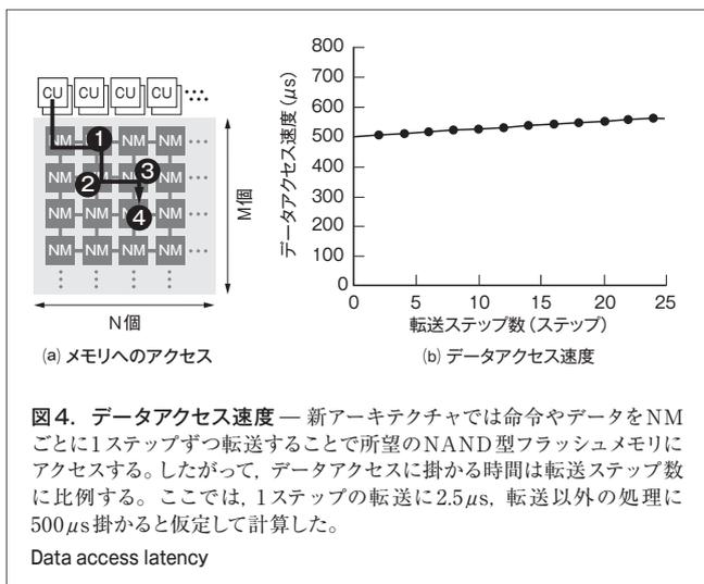
図4. データアクセス速度 — 新アーキテクチャでは命令やデータをNMごとに1ステップずつ転送することで所望のNAND型フラッシュメモリにアクセスする。したがって、データアクセスに掛かる時間は転送ステップ数に比例する。ここでは、1ステップの転送に2.5μs、転送以外の処理に500μs掛かると仮定して計算した。
