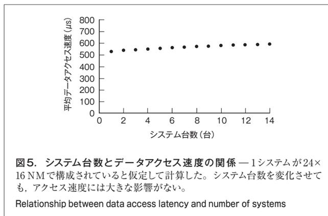
図5. システム台数とデータアクセス速度の関係 — 1システムが24×16NMで構成されていると仮定して計算した。システム台数を変化させても、アクセス速度には大きな影響がない。
