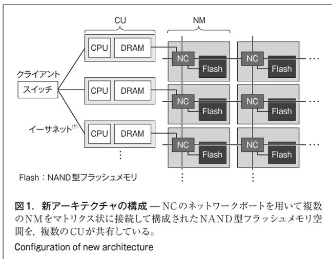
ためのネットワークポートを持っており、このポートを相互に接続することでマトリクス状の2次元ネットワークが構成されている。このNCとNAND型フラッシュメモリをまとめてノードモジュール(NM)と呼ぶ。NMの2次元ネットワークは、全体が単一のアドレス空間でアクセス可能な高速ストレージとなっている。
