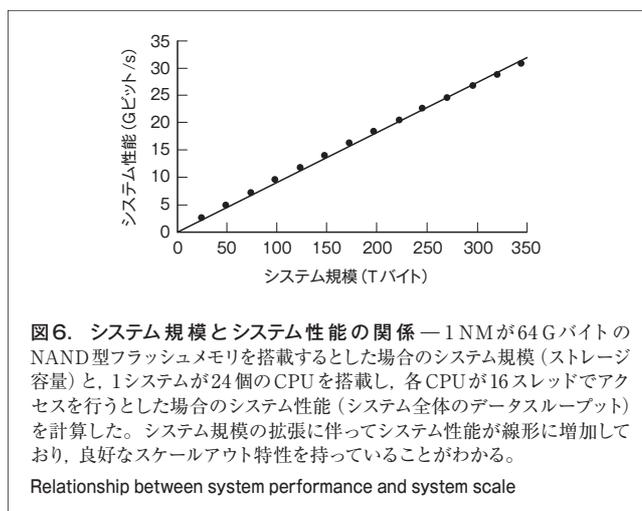
図6. システム規模とシステム性能の関係 — 1NMが64GバイトのNAND型フラッシュメモリを搭載するとした場合のシステム規模(ストレージ容量)と、1システムが24個のCPUを搭載し、各CPUが16スレッドでアクセスを行うとした場合のシステム性能(システム全体のデータスループット)を計算した。システム規模の拡張に伴ってシステム性能が線形に増加しており、良好なスケールアウト特性を持っていることがわかる。
