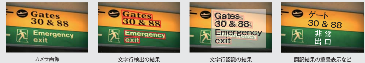
図2. カメラ画像文字認識技術の構成—カメラ画像から文字列を検出する“文字行検出”、検出結果を認識したテキストとして出力する“文字行認識”、及び認識結果に対して言語解析を行う“言語解析”の三つの技術で構成されます。
