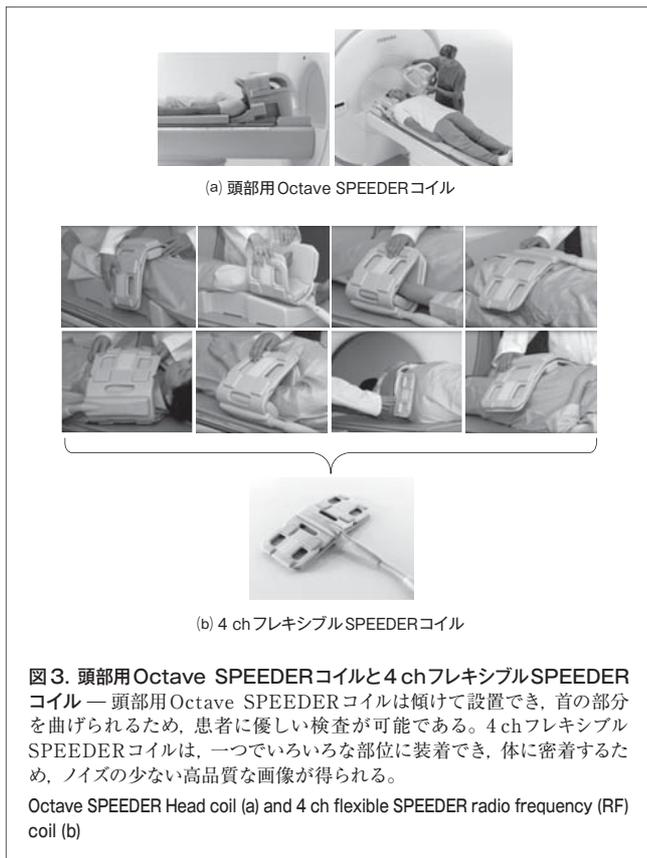
肘、足首などの形状の異なる部位に装着できる4ch（チャンネル）フレキシブルSPEEDERコイル（図3）を使用することで、少ない種類の高周波受信コイルで人体の様々な部位に対する高品質な検査を可能にした<sup>(5), (6)</sup>（図4, 図5）。
