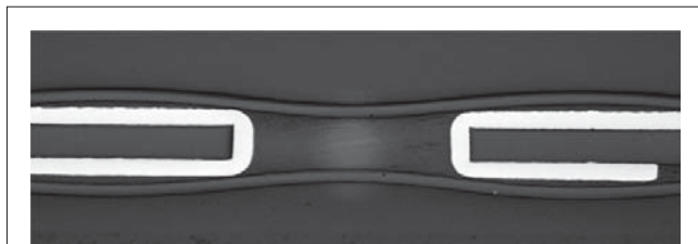
図5. 新規両面FPCの断面SEM像 — 新規FPCはダイレクトに銅めっきできるため、ベース銅箔が不要になり、一般FPCと比べて約2/3の厚さを実現できる。
