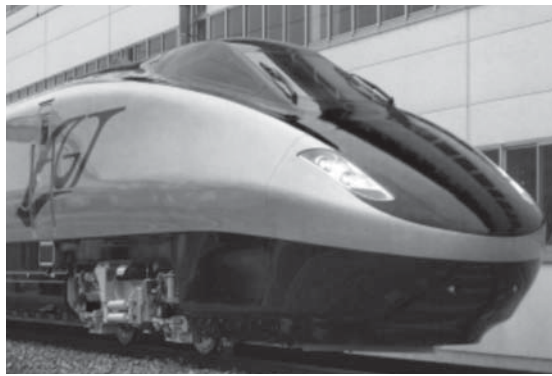
図2. FGT新試験車両—4両編成で、新幹線区間での最高速度は270 km/hである。軌間を変換することにより在来線も走行できる。 New gauge changeable train test model
