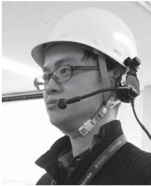
図6. ヘルメット装着型補助HIデバイス—製造現場での課題として、耐雑音性、要ハンズフリー性、及び要アイズフリー性が重要であり、その解決策として試作した。
