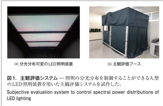
ブースの天井部分に3ユニット設置した。各ユニット間に蛍光ランプ器具も設置し、蛍光ランプ照明下での色の見えの評価も実施できるようにした。評価ブース内は、観察サンプル以外の色の影響をなくすため無彩色の灰色（マンセル色票N7相当）とした。
