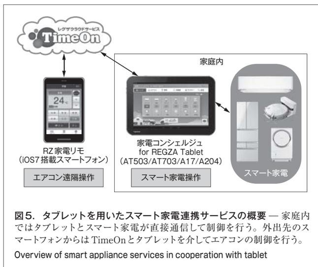
図5. タブレットを用いたスマート家電連携サービスの概要 — 家庭内ではタブレットとスマート家電が直接通信して制御を行う。外出先のスマートフォンからはTimeOnとタブレットを介してエアコンの制御を行う。
