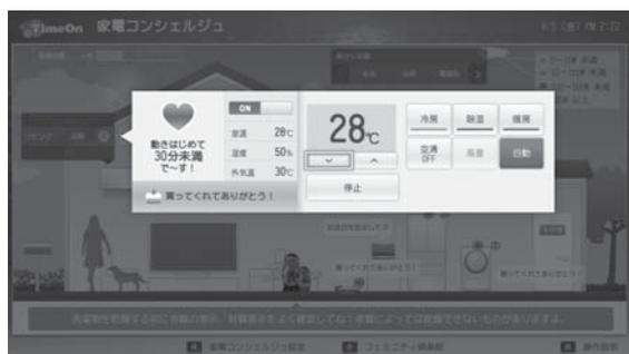
図4. エアコンの動作状況表示と操作パネル — 連続運転時間をハートマークの数で示すとともに、室温、湿度、及び外気温を確認できる。また操作パネルでは、エアコンのオン/オフ、設定温度の変更、及び運転モードの変更ができる。
