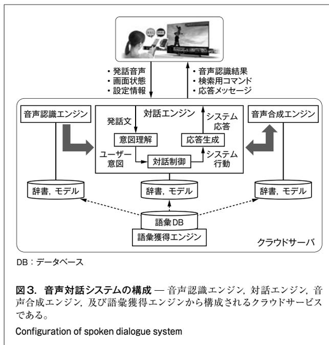
る。次に、対話エンジンが発話文とテレビの画面状態(映像表示中や番組表表示中など)と設定情報(視聴可能チャンネルやHDD(ハードディスクドライブ)接続など)を受け取り、ユーザーの意図を推定してテレビが行うべき動作を決定し、動作に応じたコマンド、応答文、及び応答文の発音情報を生成しテレビに返送する。テレビは受信したコマンドを実行するとともに、発音情報から音声合成器で生成された応答音声を再生する。語彙獲得エンジンは、テレビ番組の検索に必要な語彙(番組名や出演者名など)を収集し、音声認識や、対話、音声合成用の語彙辞書の作成に使用する。
