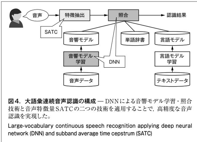
そこで、図4のように、大語彙連続音声認識の構成要素に対して、DNN (Deep Neural Network) による音響モデル学習・照合技術及び音声特徴量SATC (Sub-Band Average Time Cepstrum)<sup>(1), (2)</sup>の二つの技術を適用することで高精度な音声認識を実現した。
