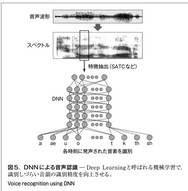
が不明瞭になりやすい場合の認識性能が向上することがこれまでにも確認されていたが、DNNへの入力として用いることで更なる認識精度の向上を達成している。
