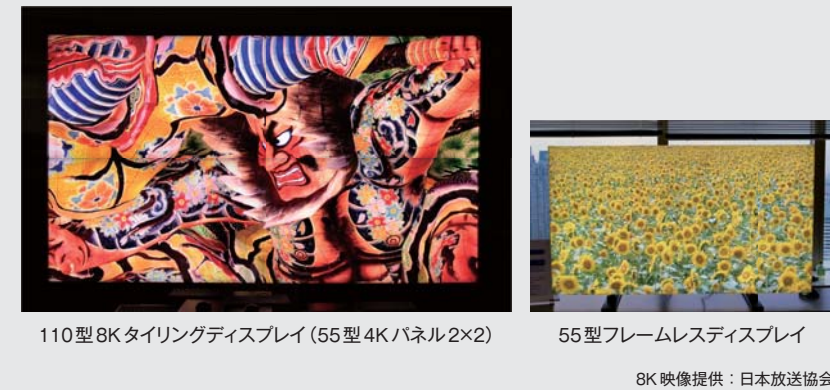
図3. シームレスタイリングディスプレイ及びフレームレスディスプレイの試作例 — 左の写真では四つのパネルの間にある約14mm幅の十字状の枠がレンズと画像補正で目立たなくなっています。
