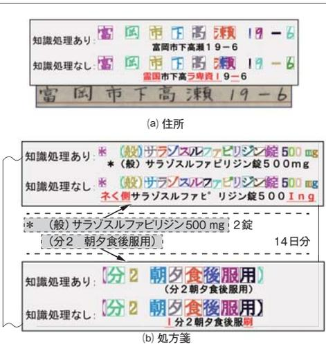
図6. 知識処理の結果の例 — 単語リストで網羅できない番地や数量などでも知識処理で誤りを補正できている。
