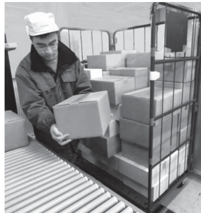
図1. 人手による荷降ろし作業 — かご台車に積載された荷物を搬送ラインに一つずつ投入する。
