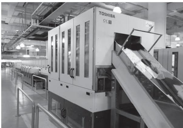
図6. 押印機能付き郵便自動区分システム — 押印機と郵便自動区分機の複合処理機である。
