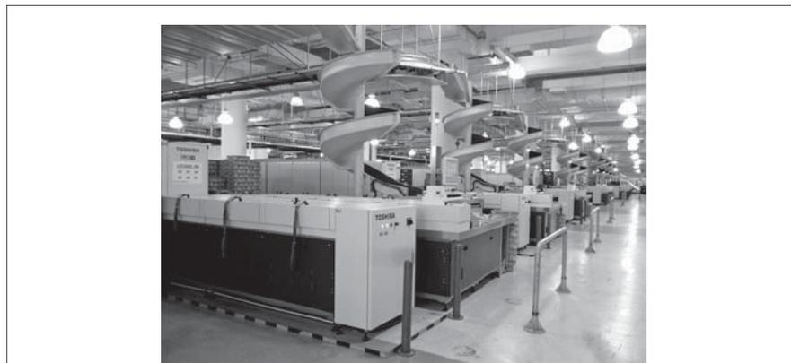
図6. 物流施設向けソリューションの例 — シンガポール郵便事業会社に区分機器、コンベヤ機器、及びITシステム一式を提供した。
