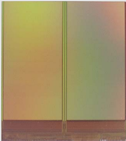
▲ 128 GビットNAND型フラッシュメモリチップ 128 Gbit NAND flash memory chip fabricated using 15 nm process
