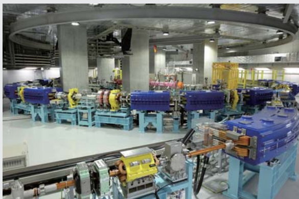
▲ 神奈川県立がんセンター 重粒子線治療装置の加速器システム Ion accelerator system for heavy-ion radiotherapy facility at Kanagawa Cancer Center
