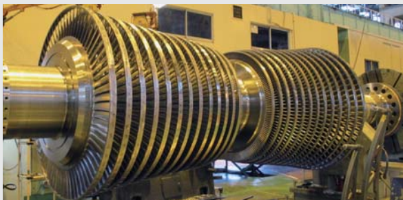
▲ クドゥギ火力発電所1号機 中圧ロータ Intermediate-pressure turbine rotor for Kudgi Super Thermal Power Project Unit 1, India
