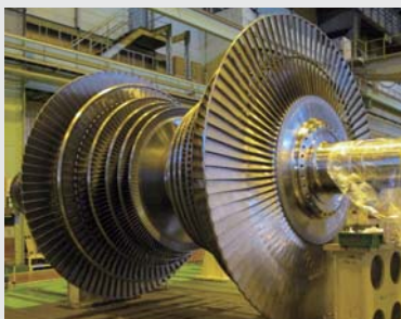
▲ クドゥギ火力発電所1号機 低圧ロータ Low-pressure turbine rotor for Kudgi Super Thermal Power Project Unit 1, India
