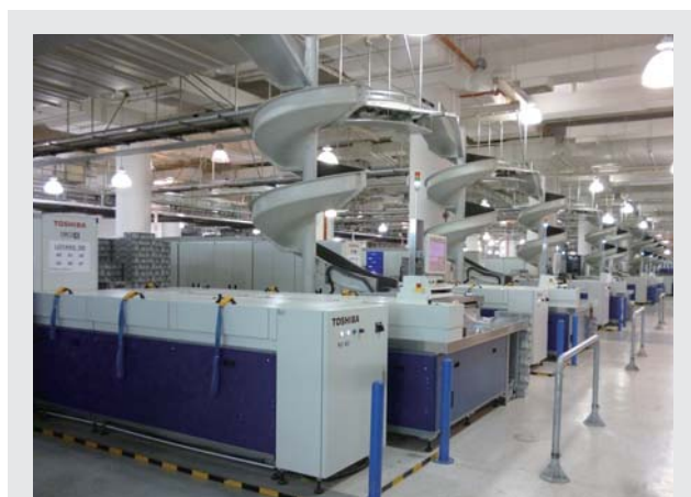
▲ 郵便物自動処理システム TT-1600 TT-1600 integrated letter sorting machine for Singapore Post Ltd.
