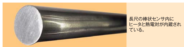
(a) 原子炉水位センサ
