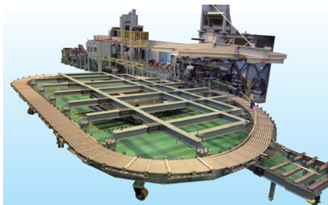
超電導導体のコイル巻線作業
