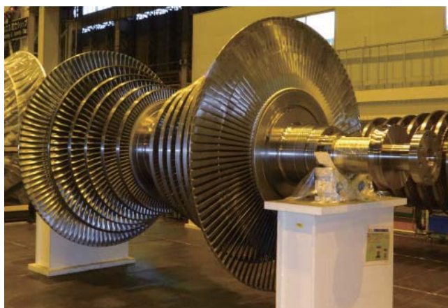
バックマン地熱発電所2号機のタービンロータ
