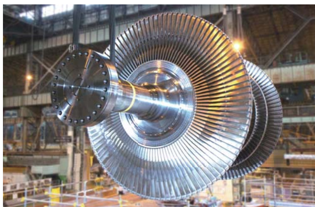
米国 サザン電力ボーグル発電所AP1000™のタービンロータ
