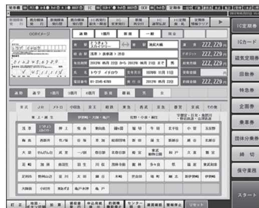
図3. 定期券発売業務の画面例 — 画面の上側に入力及び読取内容を表示し、下側に入力操作部を配置することで、画面遷移を少なくし見やすさと操作性を向上させた。
