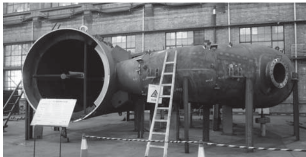
図4. 徳山発電所1号機用ケーシングの組立て — 徳山発電所の1、2号機は、ほぼ一式をTHPCで製造した。
