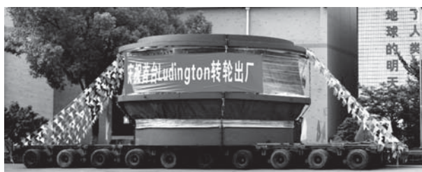
図3. ラディントン発電所用ランナの出荷 — 揚水機として世界最大級のランナを製造した。
