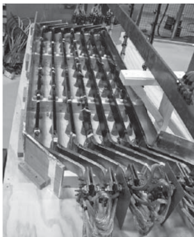
図4. ステータコイルの熱サイクル試験 — 熱サイクル試験は、ステータコイルを加熱できるヒータプレート上に配置して行われる。 Stator bars installed in jig for thermal cycle test
