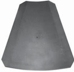
図8. 樹脂製のスラスト軸受静止板 — PTFEを主成分とした樹脂で、従来の金属製に比べ摩擦係数は約1/3、摩耗量は約1/50である。
