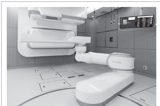
図4. 放医研新治療研究棟の治療室 — 高速3次元スキヤニング照射専用の治療室で、ロボットアーム型治療台による位置決めシステムや治療情報システムも導入されている。
