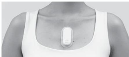
図6. Silmeeの装着イメージ—心電位を計測するため、導電性ゲルパッドを介して胸部に装着する。
