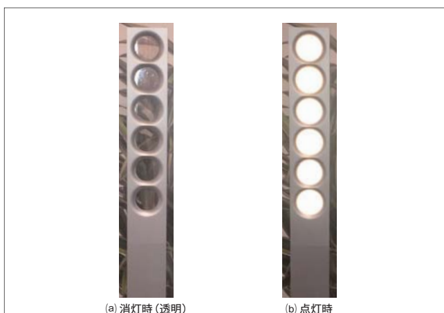
図9. 透明形有機ELアプローチライト — エクステリア用として試作した透明アプローチライトで、夜間の点灯時にはガイド灯として機能する。また、昼間の消灯時にはパネル部が円形に透けているため、前方（アプローチライトの後方）の見通しがよくなり、安全性を確保できる。 Transparent OLED approach light in on and off conditions
