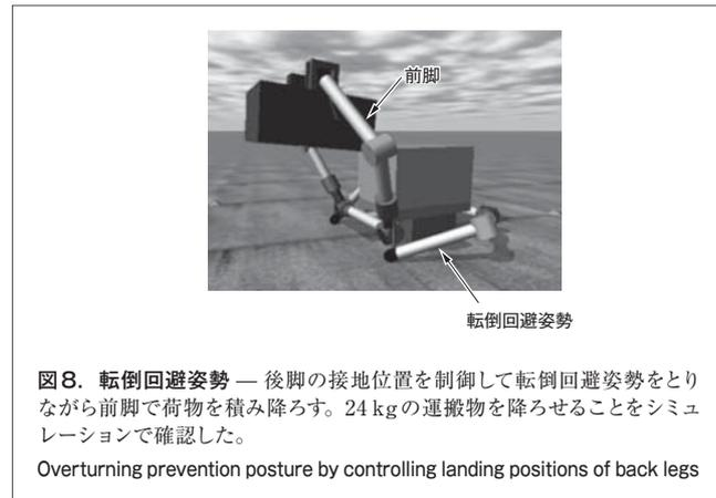
図8. 転倒回避姿勢 — 後脚の接地位置を制御して転倒回避姿勢をとりながら前脚で荷物を積み降ろす。24 kgの運搬物を降ろせることをシミュレーションで確認した。
