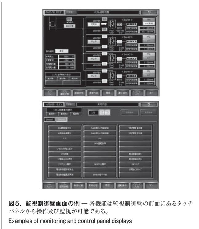
図5. 監視制御盤画面の例 — 各機能は監視制御盤の前面にあるタッチパネルから操作及び監視が可能である。
