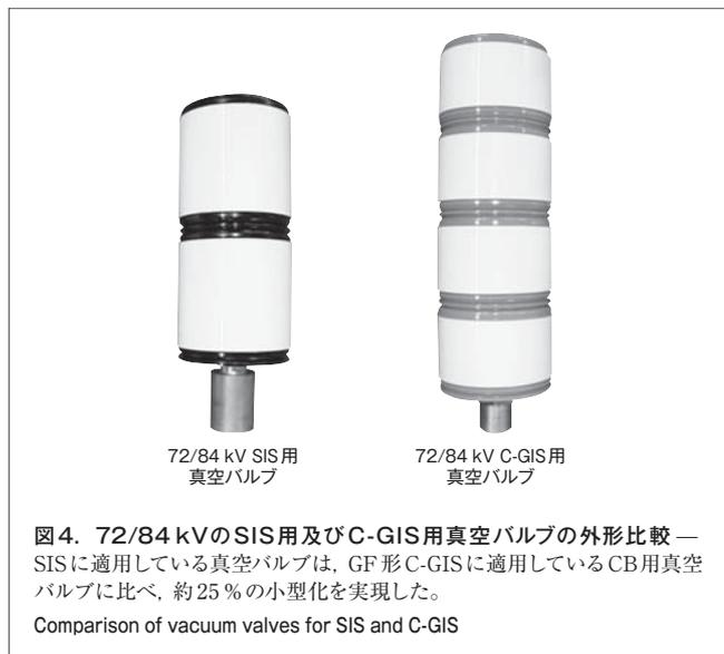
図4. 72/84 kVのSIS用及びC-GIS用真空バルブの外形比較 — SISに適用している真空バルブは、GF形C-GISに適用しているCB用真空バルブに比べ、約25%の小型化を実現した。
