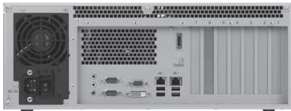
図3. FA3100SS model 1000の背面 — PCI Express (*) や各種インタフェースを搭載して高い拡張性を備えている。
