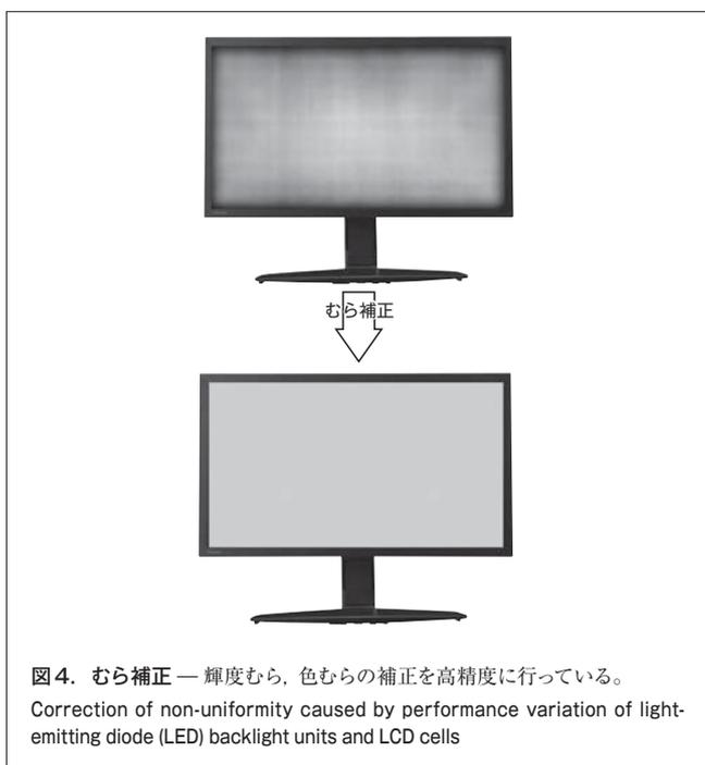
図4. むら補正 — 輝度むら、色むらの補正を高精度に行っている。
