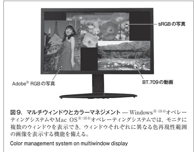
図9. マルチウィンドウとカラーマネジメント — Windows®(注4)オペレーティングシステムやMac OS®(注5)オペレーティングシステムでは、モニタに複数のウィンドウを表示でき、ウィンドウそれぞれに異なる色再現性範囲の画像を表示する機能を備える。
