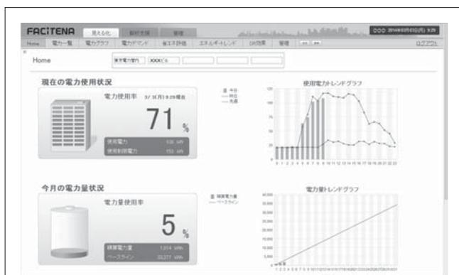
図5. ブラウザ画面例 — SFC経由で収集された使用電力量や温度などのデータは、工学値変換やカウンタの差分計算などの処理が施されて、東芝データセンターのサーバに蓄積され、ブラウザの画面に表示される。
