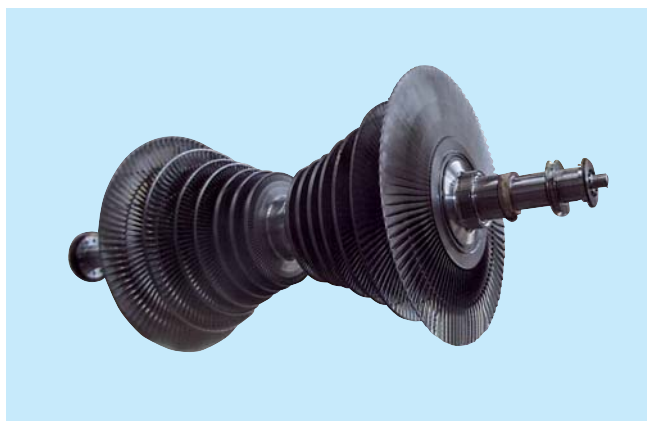
オルカリア発電所のタービンロータ
