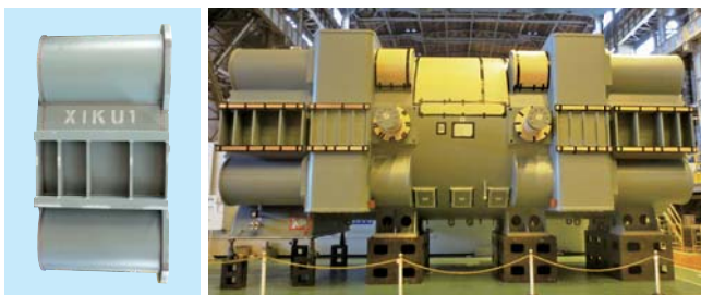
クドゥギ火力発電所1号機 発電機と3分割時の固定子端部
