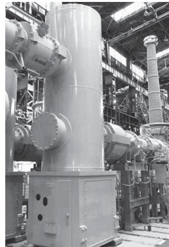
図1. 新型550 kV-63 kA-60 Hz GCB — 工場内で組立て中の新型GCBである。
