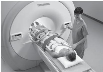
図 4. 32チャンネル Atlas SPEEDER<sup>TM</sup> コイル for 3T — 被検者の上側には 16 個の RF コイルで構成された体部用 RF コイルが三つ、背中側には 40 個の RF コイルが配置されている。最大 32 個の RF コイルを選択して 32 チャンネル同時データ収集が可能で、PI 法を用いて 10 倍近い高速撮像ができる。
