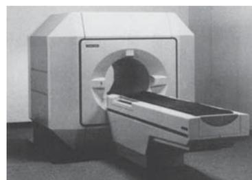
図1. NMR-CTスキャナ1号機のMRT-15A — 四つのコイルから成る空芯常電導磁石で、静磁場の均一性は40 ppm以下であった。内側に傾斜磁場コイルを備え、最大傾斜磁場強度は3.5 mT/mであった。
