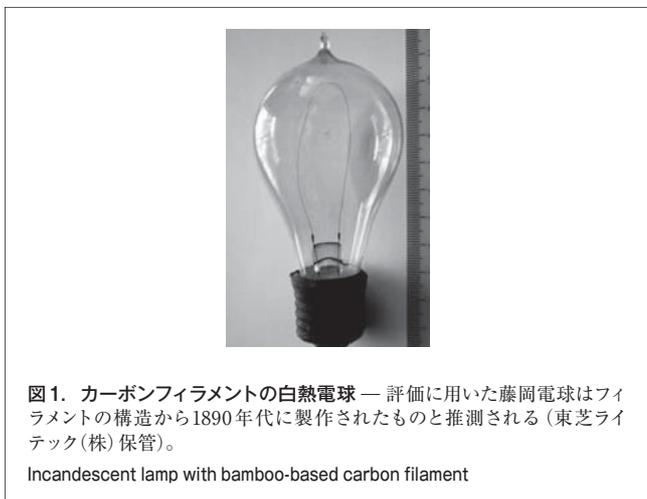
図1. カーボンフィラメントの白熱電球 — 評価に用いた藤岡電球はフィラメントの構造から1890年代に製作されたものと推測される(東芝ライテック(株)保管)。
