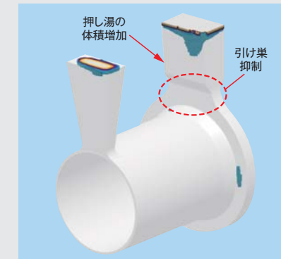
図5. 鋳造条件の改善結果 — フランジ側の押し湯体積を増加させることにより、押し湯直下の大きな引け巣を抑制できました。
