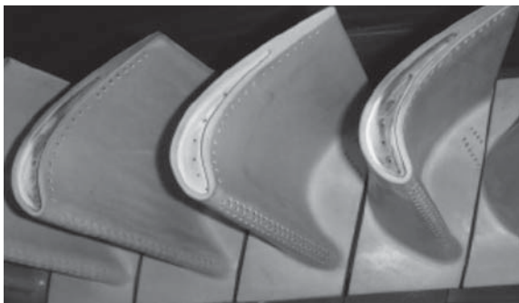
図6. ガスタービン動翼への高性能遮熱コーティング適用 — 第1段動翼へ適用した。 Turbine buckets coated with DVC-TBC
