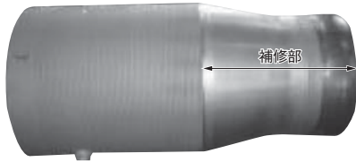
図9. 燃焼器のクーポンリペア— 燃焼器ライナへ適用し、後部スリーブを耐力強化型に交換した。 Application of coupon repair to combustion liner
