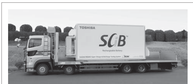
図5. 可搬型充放電試験設備 — トラックに載せて移動可能で、大型蓄電池システムの据付場所で試験を行うことができる。
