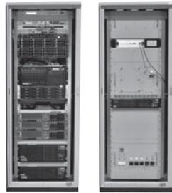
レーダ処理装置 レーダ制御装置
