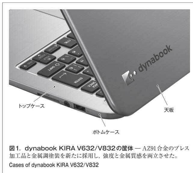
図1. dynabook KIRA V632/V832の筐体 — AZ91合金のプレス加工品と金属調塗装を新たに採用し、強度と金属質感を両立させた。
